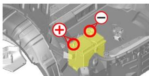
Disposición alternativa de la batería de 12 V 1
