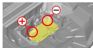
Disposición alternativa de la batería de 12 V 2
