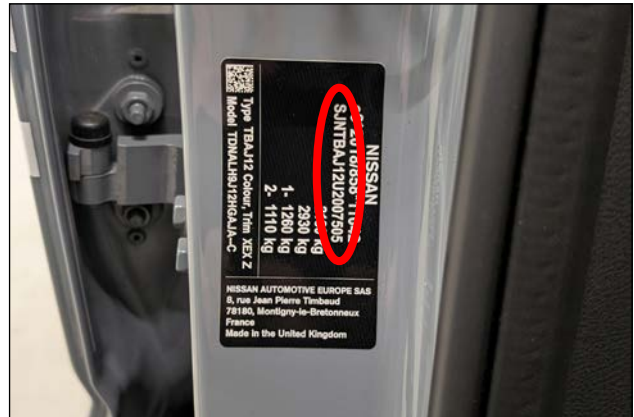
VIN en el pilar B del lado del conductor
