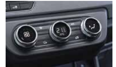
Aire Acondicionado automático [1]
