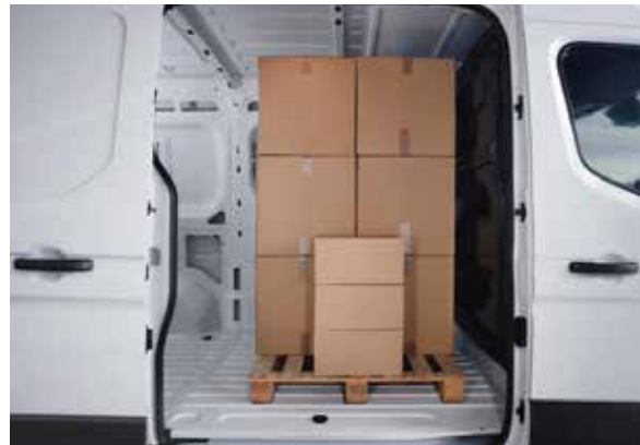
Mampara plana y no intrusiva y puerta corredera con apertura de 310 mm
